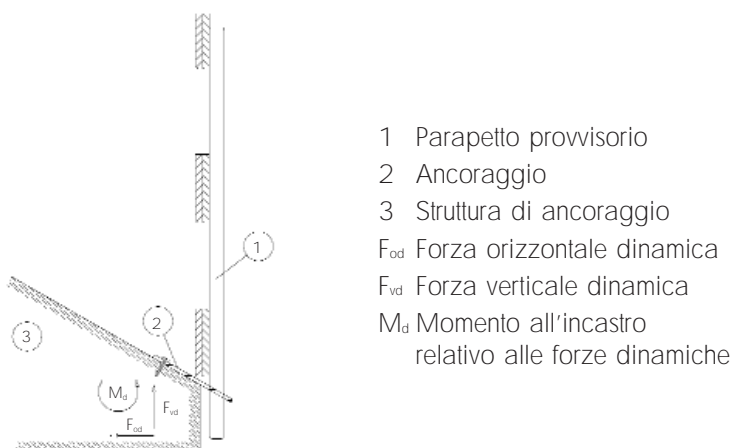
Fig. 8.1-2 Esempio di reazioni vincolari relative alle azioni dinamiche
