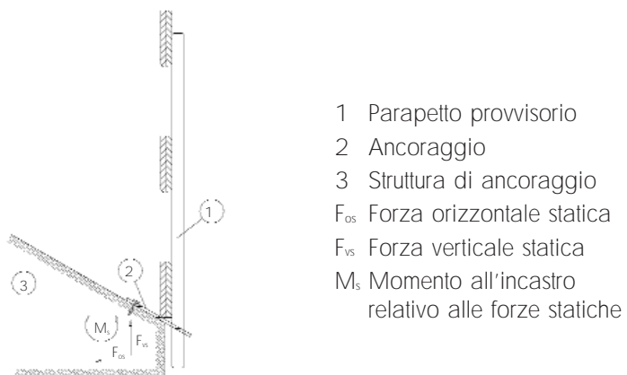
Fig. 8.1-1 Esempio di reazioni vincolari relative alle azioni statiche
