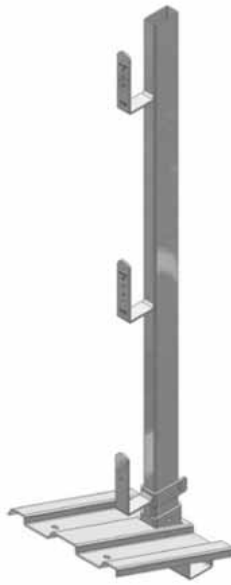
Fig. 9.1.2.1.2-2 Parapetto provvisorio ammortato con piastra inclinata
