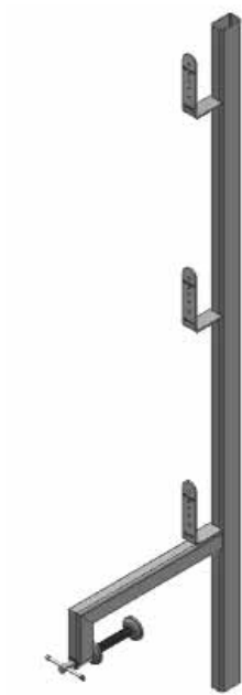
Fig. 9.1.2.1.1-1 Parapetto provvisorio ammortato con ganascia fissa
