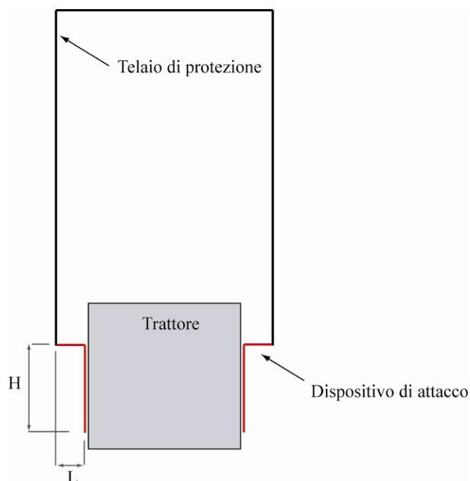
Figura 5. Conformazione e principali dimensioni del dispositivo di attacco
