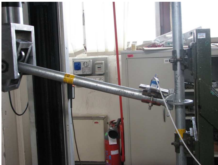
Prova di rigidezza Collegamento montante/traverso e montante /corrente
