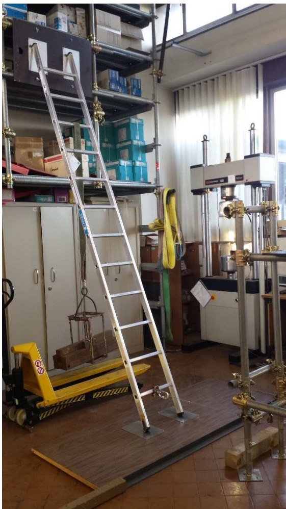
Prova di slittamento alla base
