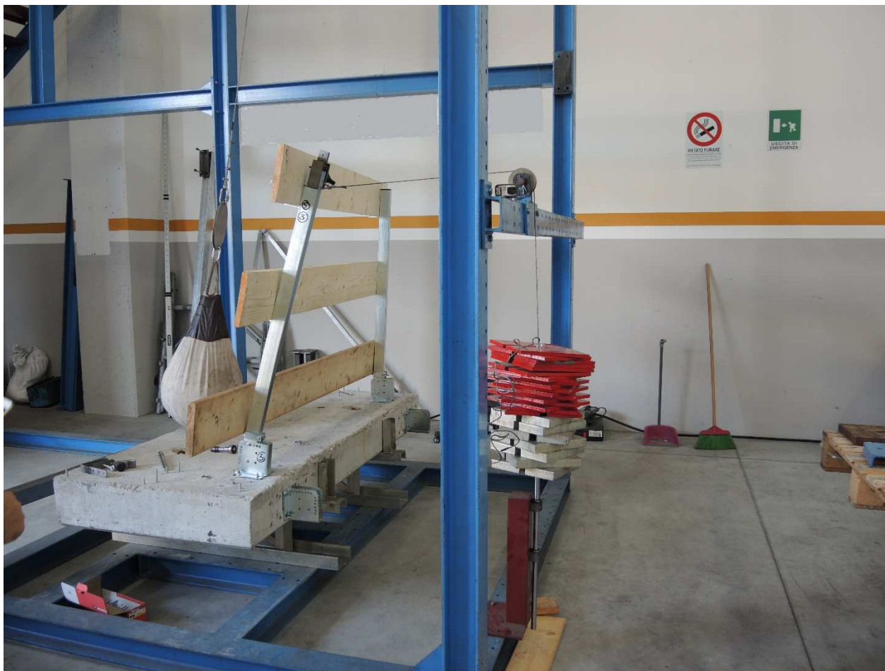
Prova statica di resistenza UNI EN 13377
