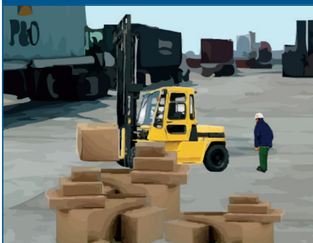
Figura 3 Criticità: area di lavoro priva di percorsi definiti per mezzi e pedoni
