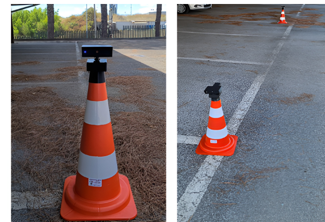
Figura 3. Sperimentazione di due elementi modulari di barriera "attiva" in un'area all'aperto, adiacente all'area di transito dei veicoli. Fonte: Inail.
