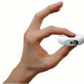
Figura 6 - Caso numero 5: un piccolo sensore avvicinato alla fronte del consumatore ne rileva i parametri vitali (frequenza cardiaca, temperatura corporea, pressione sanguigna, frequenza respiratoria, ossigenazione del sangue e stress emotivo) e li invia ad uno smartphone dove vengono registrati ed elaborati.
