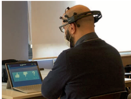
Figura 7 - Caso numero 7: dispositivo composto da un caschetto e un tablet , collegati in bluetooth : il caschetto intercetta l'attività elettrica dell'encefalo e la trasmette al computer che permette all'utilizzatore di comunicare con il mondo che lo circonda.
