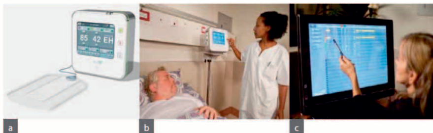
Figura 3 - Caso numero 2. Il sensore (a) contact-free e wireless posizionato sotto il materasso (o sotto alla seduta) del paziente rileva frequenza cardiaca, respiratoria e i movimenti del letto, e proietta i parametri vitali su un monitor posto al lato del letto (b) e un altro all'esterno della stanza (c), per consentire un costante monitoraggio e controllo della situazione clinica.
