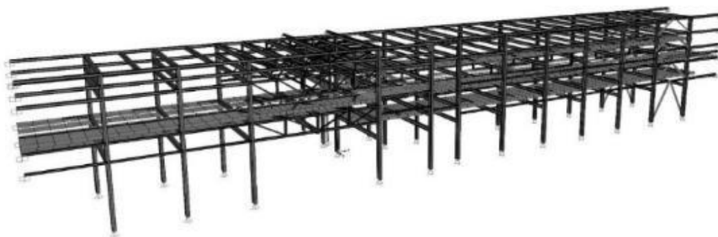
Figura 30 - Modello agli elementi finiti di un piperak con annesse tubazioni
