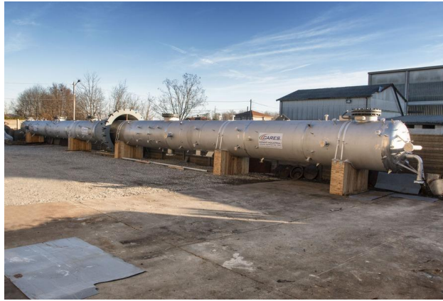
Figura 19 - Esempio di serbatoio orizzontale
