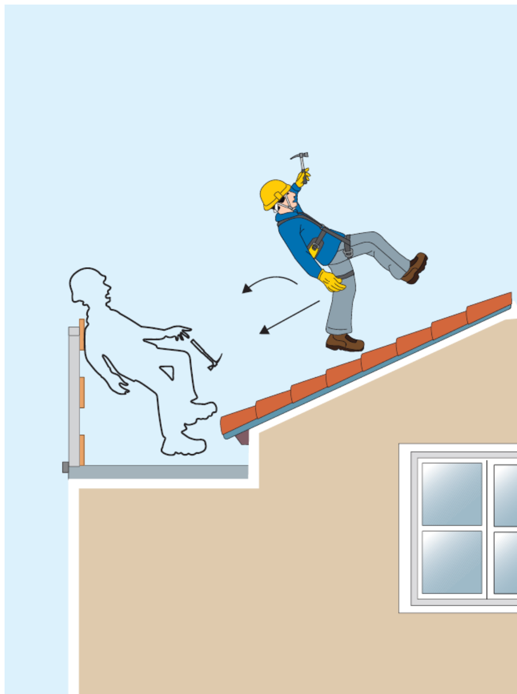
Figura 3 - Inclinazione della superficie di lavoro (inciampo)
