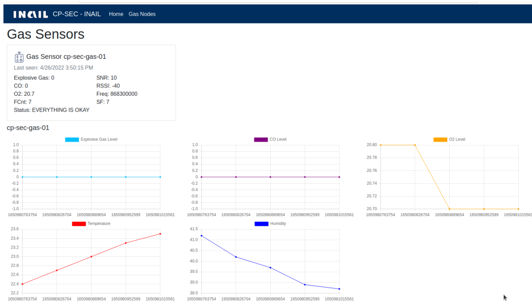
Figura 6.2-2 Pagina di dettaglio dei valori di gas nella dashboard di visualizzazione dati di CP-SEC
