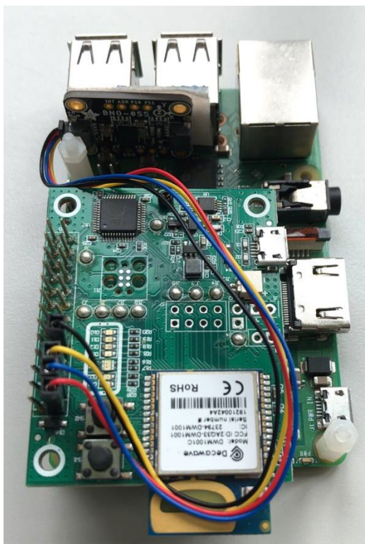
Figura 4.2-3 RPi3 connessa alla IMU ed al tag UWB DWM1001
