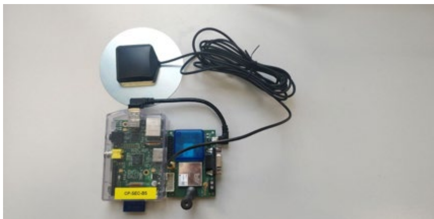
Figura 4.3-6 Setup hardware per i prototipi di localizzazione indoor
