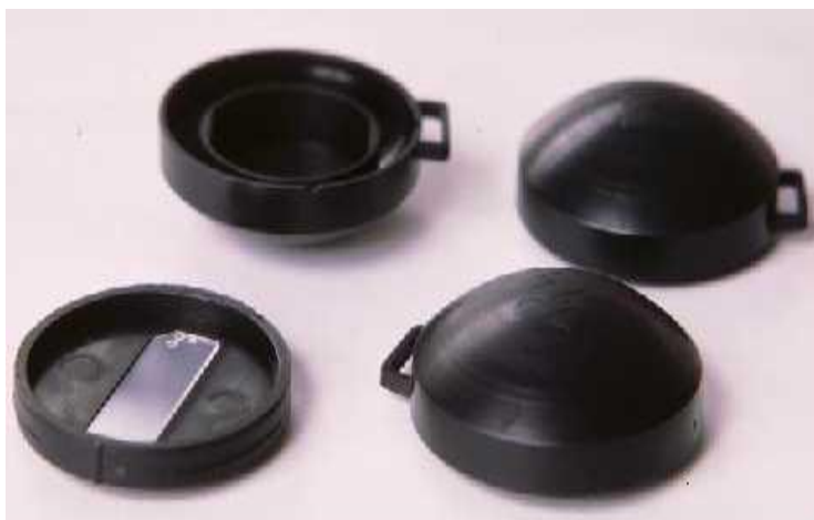
Fig. 1 – Dosimetro passivo tipo NRPB/SSI con rivelatore di CR-39
