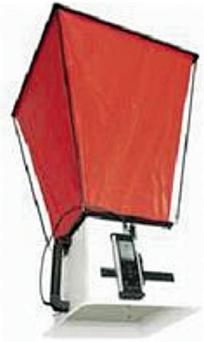
Sonda convogliatrice per anemometri
