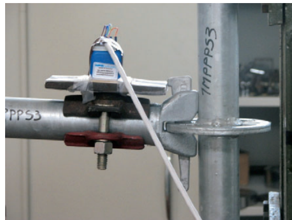
Figura 4.2.2.4-4: Formarsi di aria al contatto tra il montante e la forchetta del traverso (evento a)
