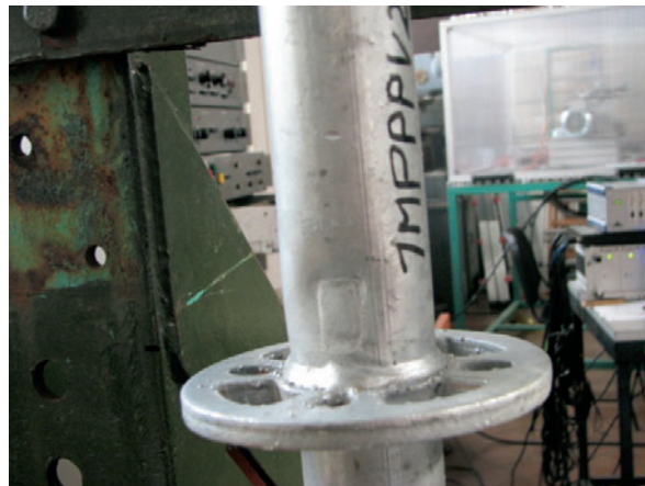
Figura 4.2.2.2-7: Fine prova - Deformazione permanente del montante al contatto con la forchetta
