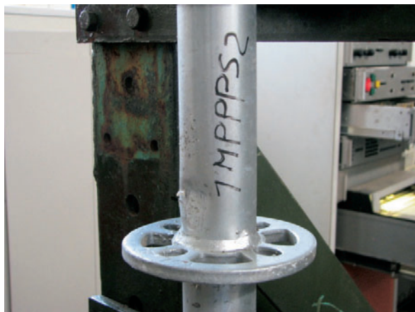
Figura 4.2.2.3-6: Fine prova - Deformazione permanente del montante al contatto con la forchetta dettaglio 1
