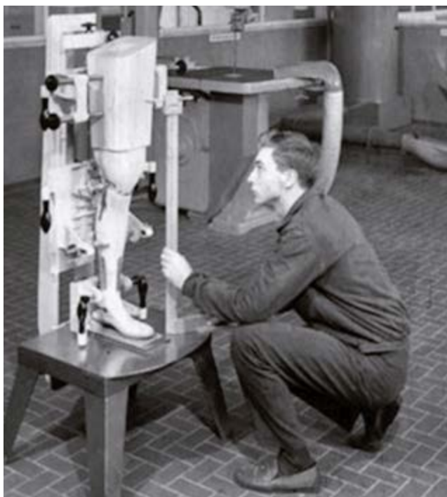
Sistema di allineamento protesi transfemorale anni '70
