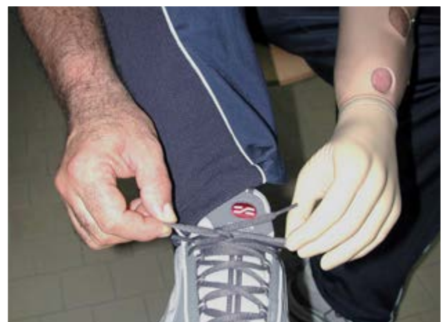
La mano tridigitale ha evidenti limiti rispetto alla più evoluta mano poliarticolata. La presa avviene con l'opposizione del pollice all'indice e al medio, mentre le altre due dita rimangono passive
